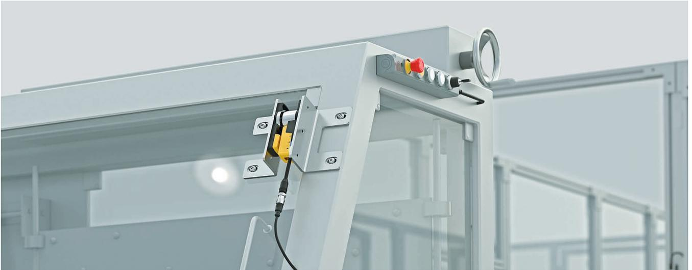
Prozesszuhaltung HOLDX RS1 an einer Schiebetür, tGard-Bedieneinheit zur Steuerung der Anlage
