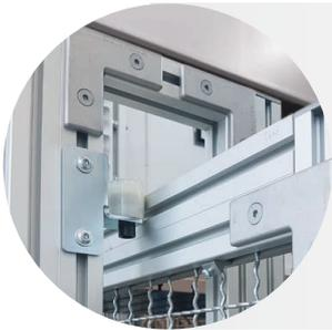
Die "SSP-Fast-Connect-Technologie" erlaubt eine schnelle Verbindung der Aluminiumprofile. Bohren und Gewindeschneiden ist nicht mehr notwendig.
