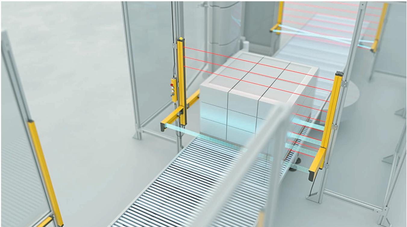
T-Muting mit M5-Mehrstrahlsensoren für komplexe Ladungen und partielles Muting
