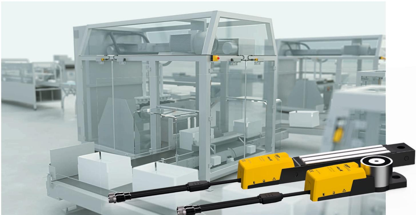
Verpackungsanlage mit sechs Prozesszuhaltungen HOLDX RS2, intelligent in Reihe geschaltet
