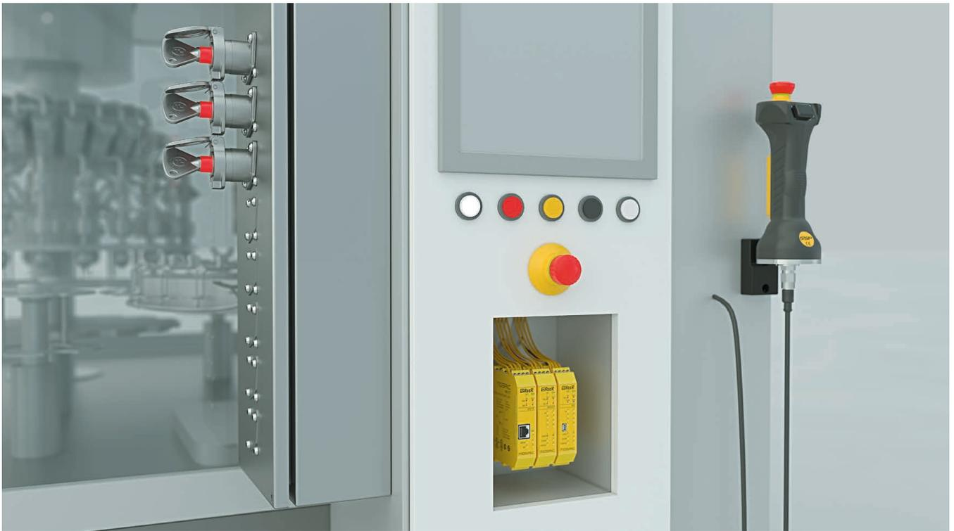
Sichere Drehzahlüberwachung mit der MOSAIC Sicherheitssteuerung, ZEUS Zustimmungstaster, EDI Not-Halt-Taster, Simplifier Tasterelemente
