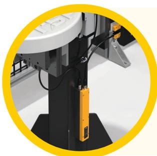
En la estación de herramientas, el Safety Simplifier supervisa que el robot cambie de herramienta de manera segura.
