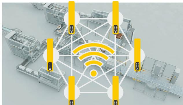
El Safety Simplifier garantiza que las señales de seguridad lleguen a su destino de la forma más rápida, fiable y segura mediante una red mallada inalámbrica.
