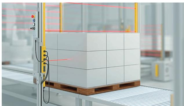
Los palets complejos o los componentes pequeños pueden retirarse de forma segura con la función de esclusa de SSP lista para usar.
