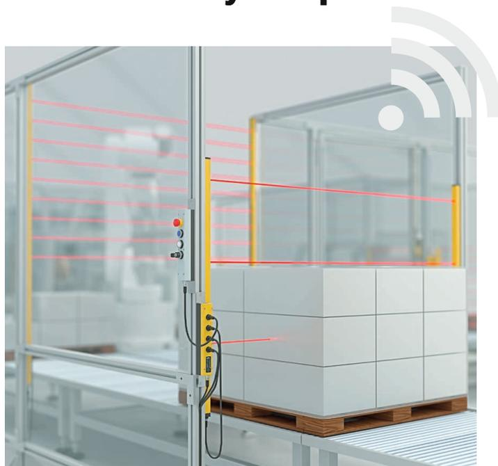
Función de esclusa del Safety Simplifier con rejillas ópticas EOS4 para retirar palets
