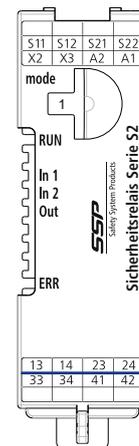
Die Sicherheitskontakte 13-14 und 23-24 erfüllen gegen alle anderen Anschlussklemmen, ohne zusätzliche Maßnahmen, die Anforderungen für doppelte Isolierung gemäß IEC/ EN 60664-1 und sind bei Schaltspannungen > 50 V zu verwenden. Die Sicherheitskontakte 33-34 erfüllen die Anforderungen für Basisisolierung.
