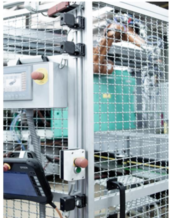
EUROMAP 73 Absicherung mit drei Sicherheitsschaltern an der Schutztür.
