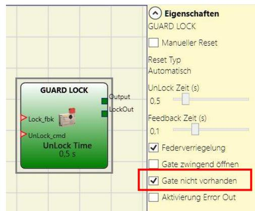
Das Output-Signal befindet sich auf Ebene LL1 (TRUE), wenn die Schutztür geschlossen und die Verriegelung blockiert ist. Wird ein Freigabebefehl auf den Eingang UnLock\_cmd angewendet, wird das Output-Signal auf LL0 gebracht und die Verriegelung wird mit dem LockOut-Signal freigegeben.
