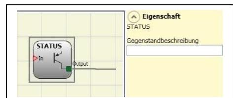
**ACHTUNG:** der Ausgang STATUS ist KEIN sicherer Ausgang.
