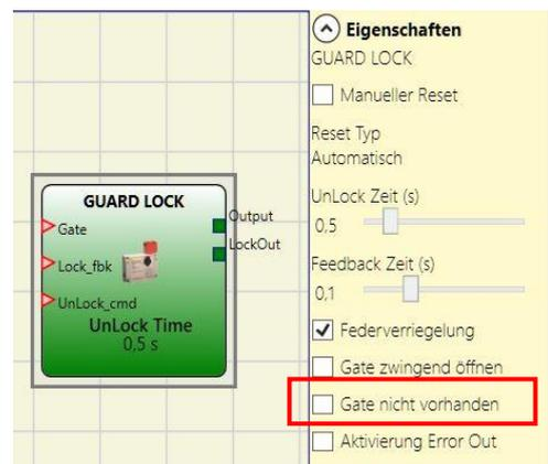
Das Input UnLock\_cmd kann im Schaltplan beliebig angeschlossen werden und bestimmt die Anfrage der Freigabe der Verriegelung (wenn auf LL1).
