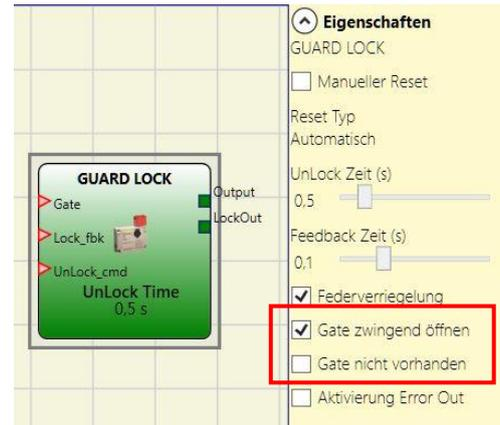
Der Eingang Lock\_Fbk muss notwendigerweise an ein Input-Element des Typs "LOCK FEEDBACK" angeschlossen sein (siehe Kapitel LOCK FEEDBACK S. 94), das den Status des Elektromagneten der Verriegelung erfasst.
