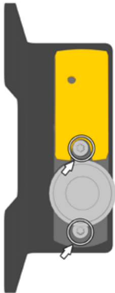
Abb.7: Prozesszuhaltung auf Montageplatte anbringen und Schrauben M6 x 25 mm Torx festziehen.
