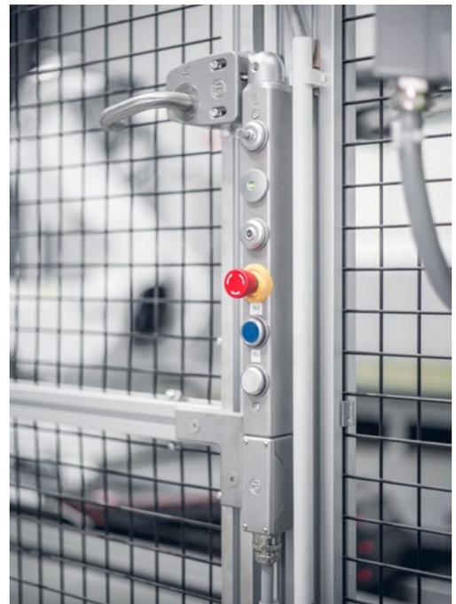
Sicherheitsschalter amGard pro mit Schlusseltransfersystem und tGard mit Bedienelementen: Die passende Montageplatte ist als Zubehor fur jede Schalterkonfiguration erhaltlich. Der Sicherheitsschalter tGard lasst sich, dank seiner schmalen Bauform, auch direkt auf das Aluminiumprofil montieren.
