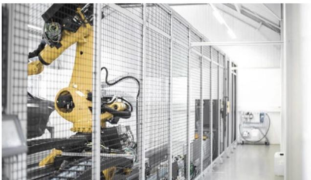
Stabile Punktschweißgitter mit verstärkender Fixierungstechnik und robusten Aluminiumprofilen. SSP-Schutzzäune werden mit Hilfe von Pendel- und Beschusstests regelmäßig geprüft.
