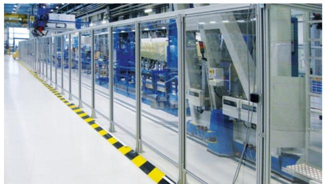
Mit Polycarbonat-Füllungen bleiben Maschinen perfekt einsehbar und bieten neben Eingriffsschutz und Absicherung auch optisch ansprechende Maschinensicherheit.
