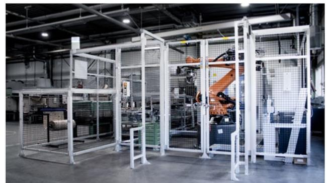
Der Zaunverlauf folgt dem Maschinenverlauf und der Applikation. Winkel, Schrägen, Füllungen und vieles mehr können mit dem Modell Flex-Line individuell gestaltet werden.
