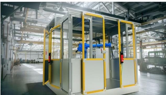
Das SSP-Schutzzaun-System eignet sich für einfache Zaunstrecken, für komplexe Maschineneinhausungen und zum Einhausen von Roboteranlagen, Maschinen und Handarbeitsplätzen.
