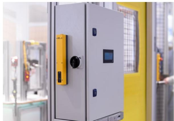
Die Torsteuerung lässt sich mit der Safety Simplifier Sicherheitssteuerung kombinieren
