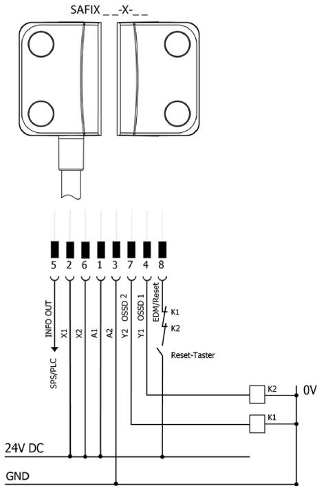
Abb. 9: Direkter Anschluss zweier Schützen nach PL e, SAFIX \_\_-X-\_\_
