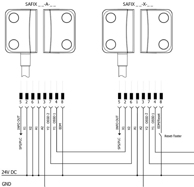
Abb. 8: Eingang eines Reset-Tasters + jeder Türkreis kann quittiert werden, SAFIX \_\_-X\_\_-
