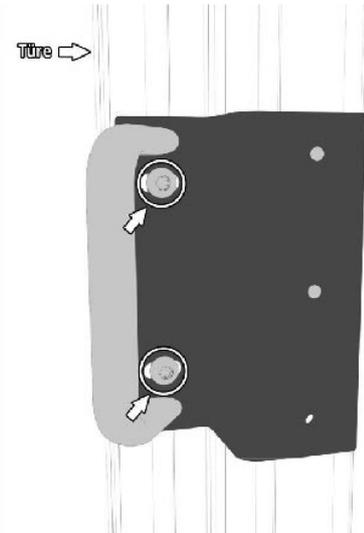
Abb.6: Montageplatte mit Ankerplatte am Profil anbringen und zur Prozesszuhaltung ausrichten. Schrauben M8 x 12 mm Torx festziehen.
